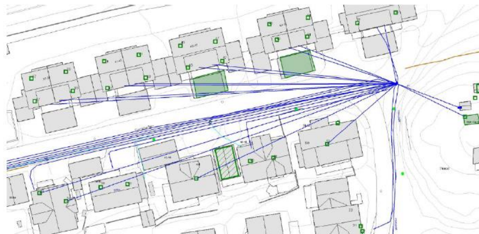
Figur 2 Eksempel på «Ledningskart» med rette linjer mellom koplingspunkt og terminering hos abonnent. Her må ledningene påvises og innmåles hvor kablene går dersom det skal graves mellom husrekke.
